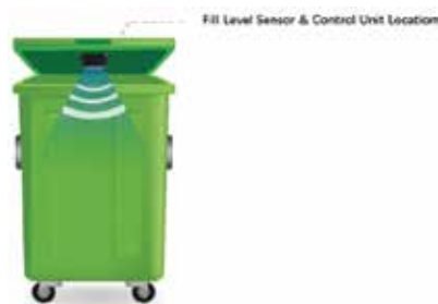
回收桶內安裝超聲波存量感應器
