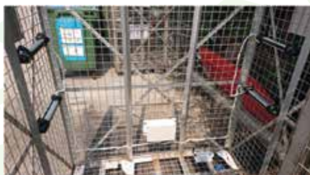
已安裝紅外線存量感應器的金屬籠
